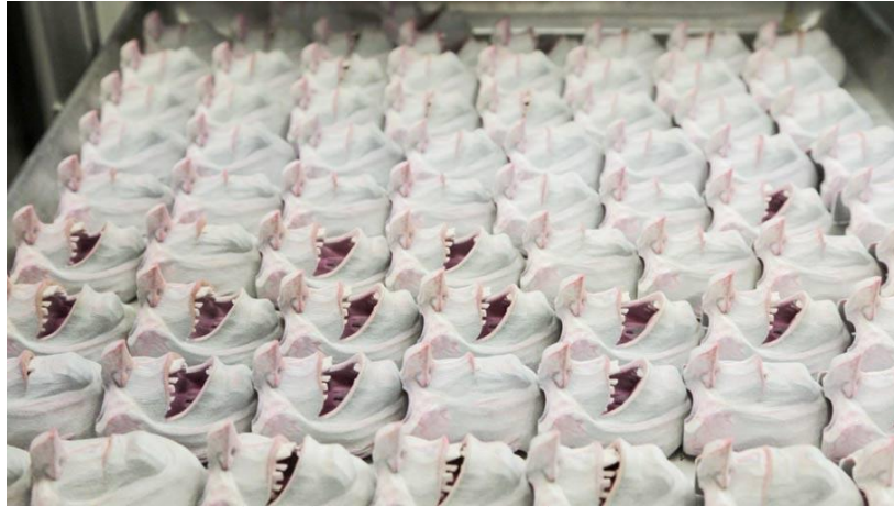
شكل 7: بعد الانتهاء من الوجوه المطبوعة، تستمر عمليات المعالجة البعدية؛ لضمان الاتساق في الشكل واللون
