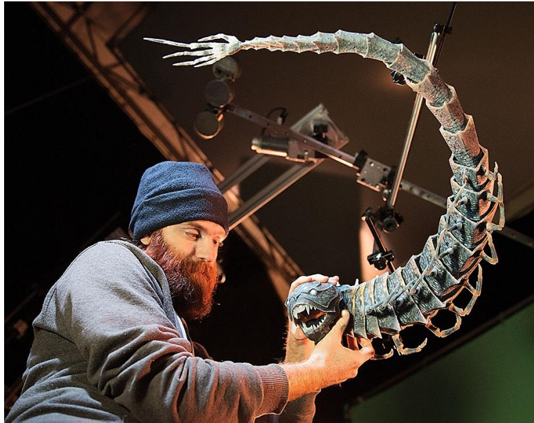
شكل 23: أول دمية مطبوعة ثلاثية الأبعاد بالكامل من Laika مكونة من 881 قطعة
