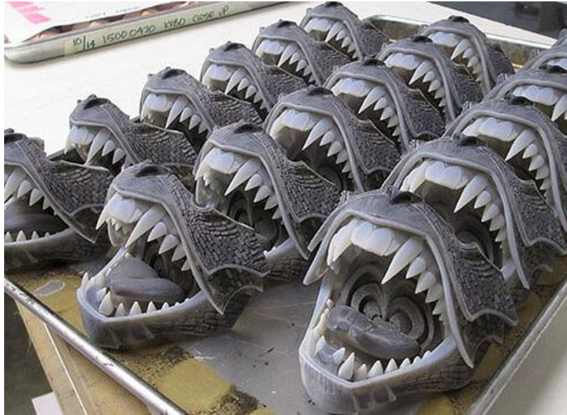
شكل 21: بعض أجزاء دمية وحش القمر المطبوعة ثلاثية الأبعاد (الفك). المصدر: https://3dprintingindustry.com/news/laika-15000-3d-printed-gore-p-91654
