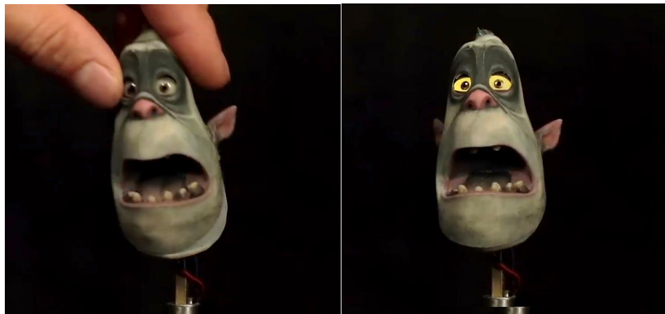
شكل 12: يمين: قبل توصيل الأقطاب المغناطيسية، يسار: بعد تركيب الوجه البديل مما أدى لتوصيل الأقطاب المغناطيسية ببعضها وبالتالي توصيل الإضاءة. المصدر: https://youtu.be/0i29loX06A4
