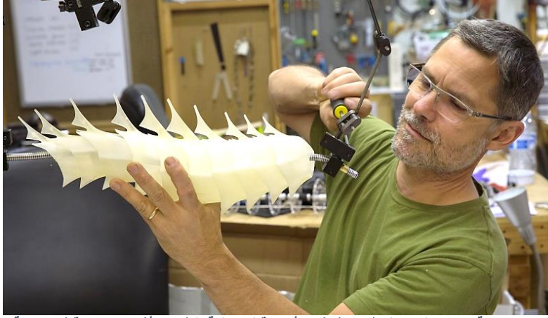
شكل 22: جسم دمية وحش القمر المطبوع ثلاثي الأبعاد قبل عملية الطلاء وأثناء تجميع قطع جسمه سوياً. المصدر: https://www.indiewire.com/awards/industry/kubo-and-the-two-strings-laika-moon-beast-1201751080
