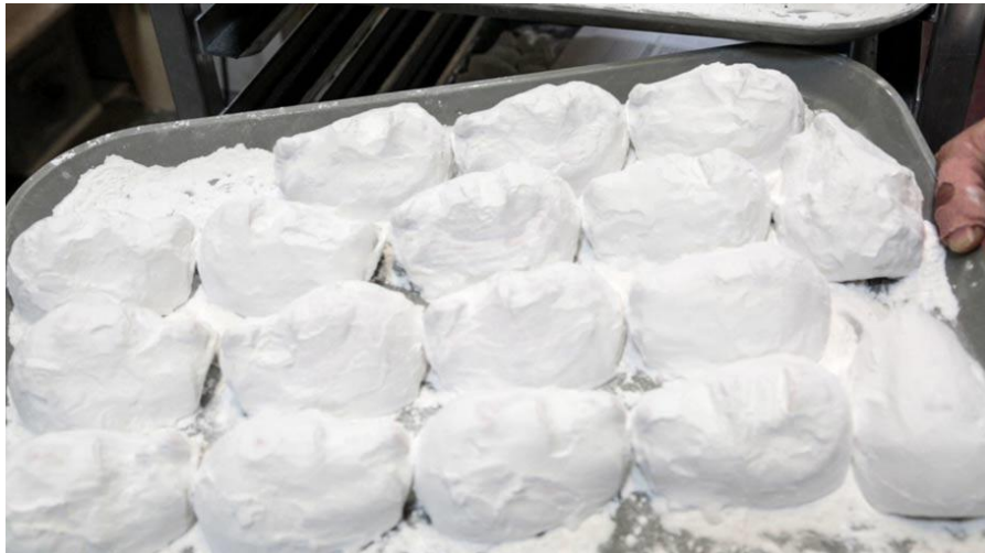
شكل 5: وجوه الدمى فور الانتهاء من طباعته وقبل القيام بعمليات المعالجة، يظهر استخدام المادة التي تشبه الجص الأبيض
